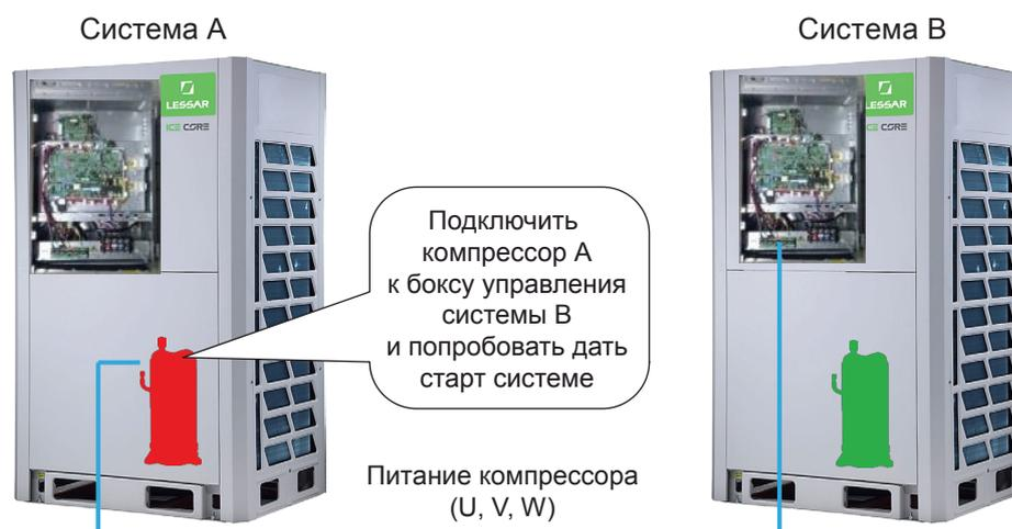
При отсутствии нормально работающей системы рядом заменить основную плату управления. Если после замены платы не удалось запустить компрессор, замените компрессор.
