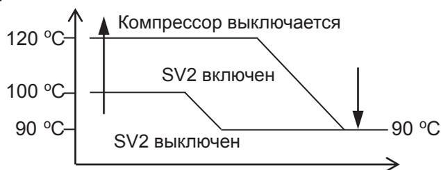
Когда температура нагнетания поднимается выше 120 °C, система отображает защиту P4, и все агрегаты останавливаются. Если защита P4 срабатывает 3 раза за 100 минут, отображается ошибка H6. Ошибка H6 сбрасывается только отключением электропитания.
