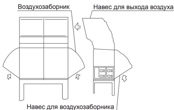
Если вокруг наружных блоков присутствуют стены, их высота должна быть ниже верхнего уровня наружного блока на 800 мм. Если это условие не может быть выполнено, предусмотрите монтаж дополнительных коробов для исключения смешивания отработанного и свежего воздуха.
