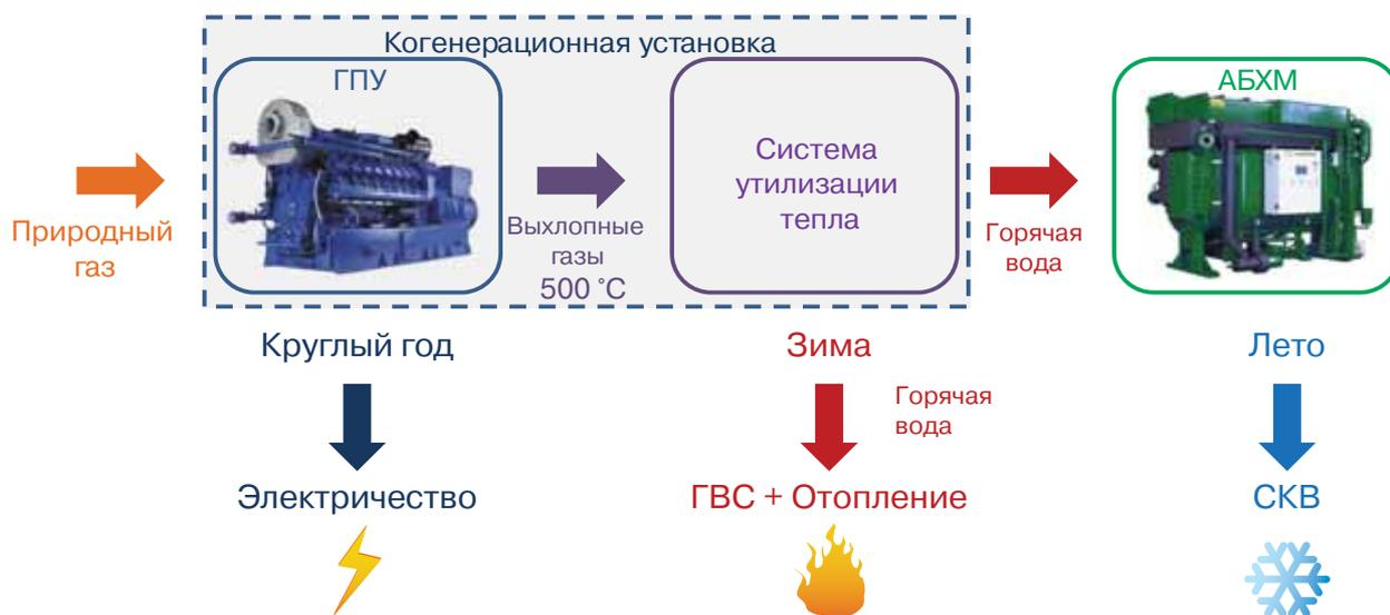
Рис. 2. Вариант применения АБХМ в системах тригенерации
