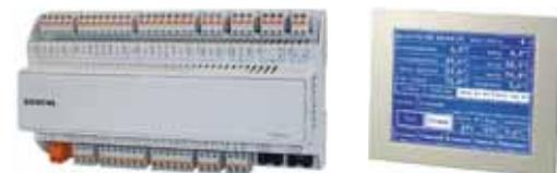
Полная автоматизация посредством программируемого логического контроллера Siemens со встроенной поддержкой протокола обмена данными ModBus. Цветная сенсорная панель оператора, расположенная на лицевой панели шкафа управления. Полностью русифицирована
